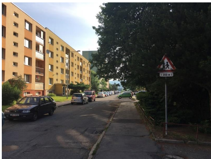
Obrázek 187 Zeleň částečně zakrývající dopravní značení
